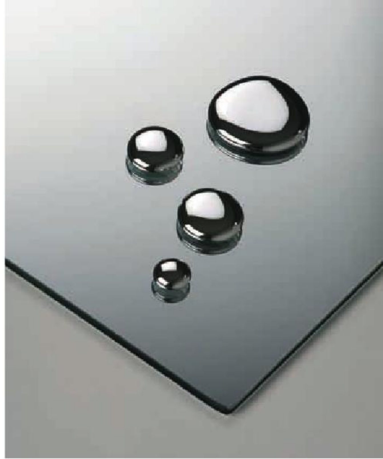
Metal en estado líquido. El mercurio se dilata y expande con el calor, por eso se usa en los termómetros.
